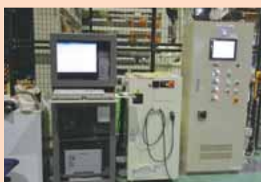
加工指示書データを受け取り、自動刃組装置へ指示を出す機械
