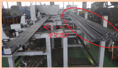
切断されずに残った丸棒を手で流す。
