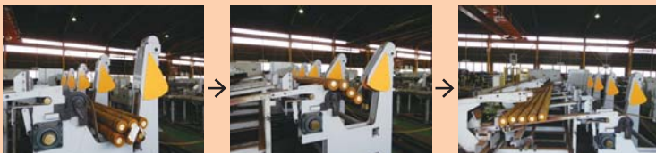
合計4tの材料を自動で連続切断できるため、手での流し作業が不要になった。
